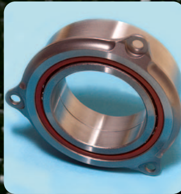
Roulement à billes à portée conique, double rangée, flasqué, avec cage phénolique, en mesure de recevoir des charges axiales dans les deux sens, ainsi que des charges radiales. Jeu / précharge conforme aux exigences.
