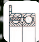
Roulement à billes à portée conique, double rangée, flasqué, avec cage phénolique, en mesure de recevoir des charges axiales dans les deux sens, ainsi que des charges radiales. Jeu / précharge conforme aux exigences.
