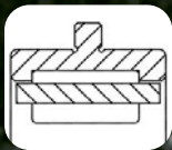
Roulement à billes duplex flasqué, idéal pour les charges axiales dans les deux sens. Jeu axial / précharge conforme aux exigences du client.
